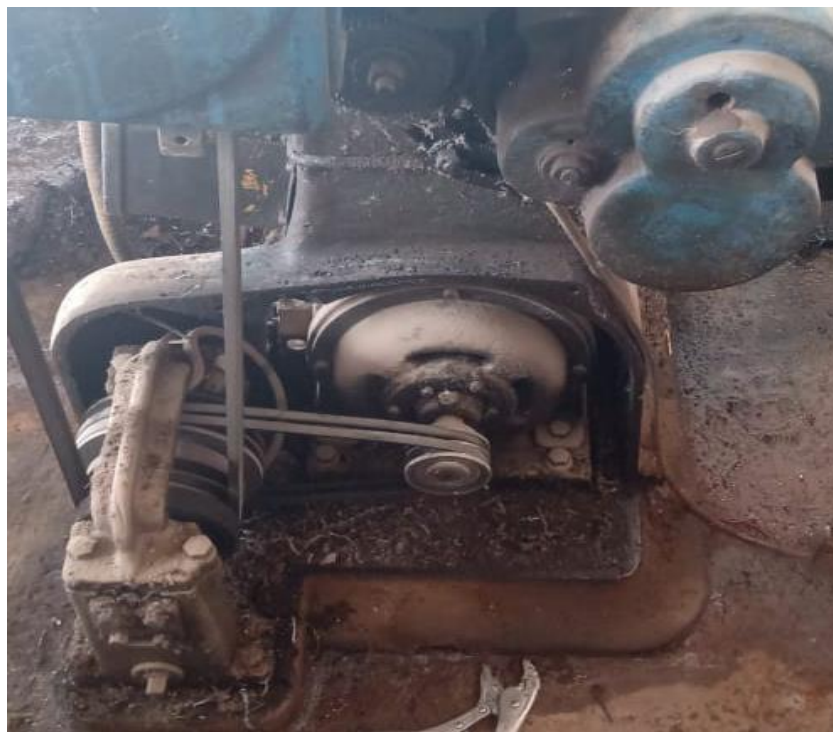
Figura 15. Bandas antes del mantenimiento.
