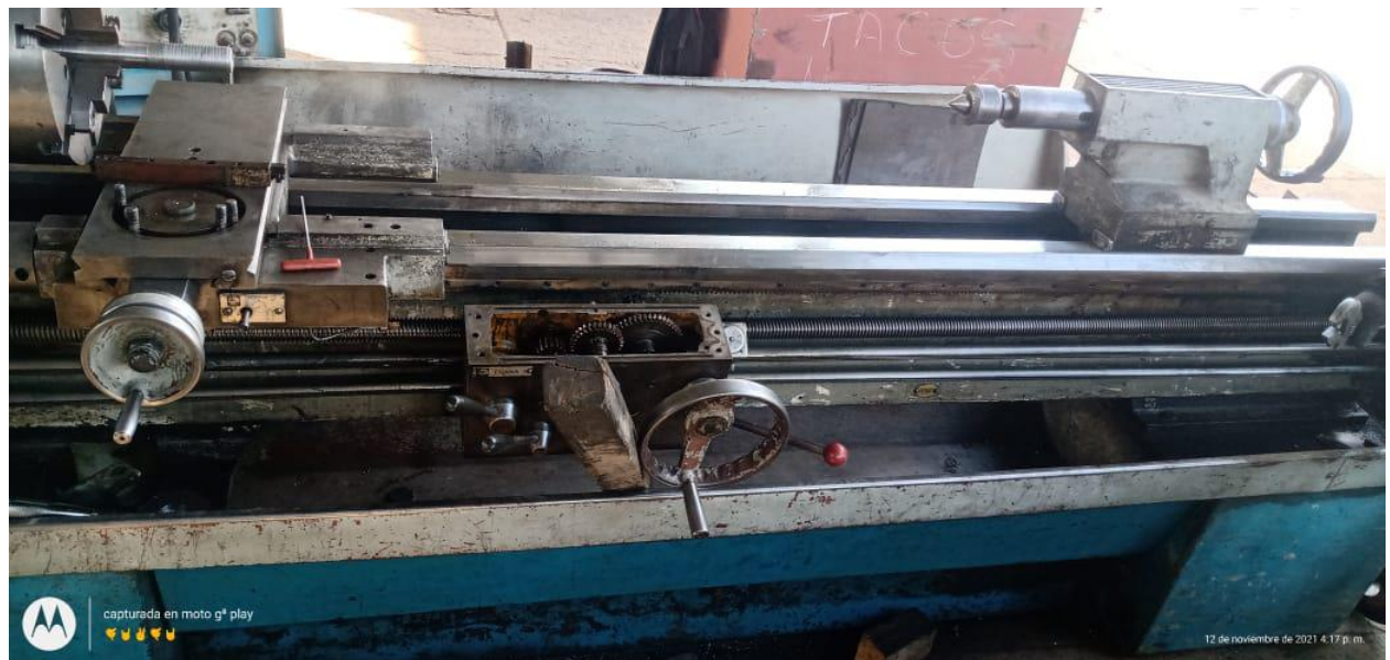
Figura 22. Desmontaje de caja de automático.
