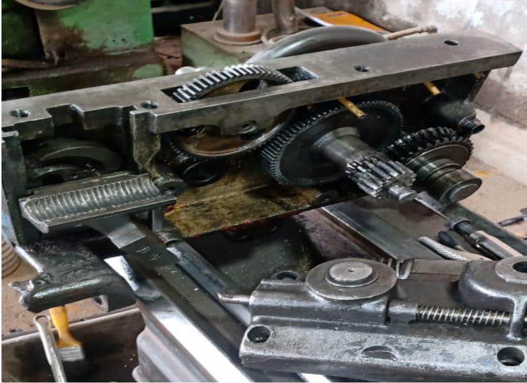
Figura 9. Revisión de caja de automático.
